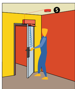
Tür mit Servoantrieb
